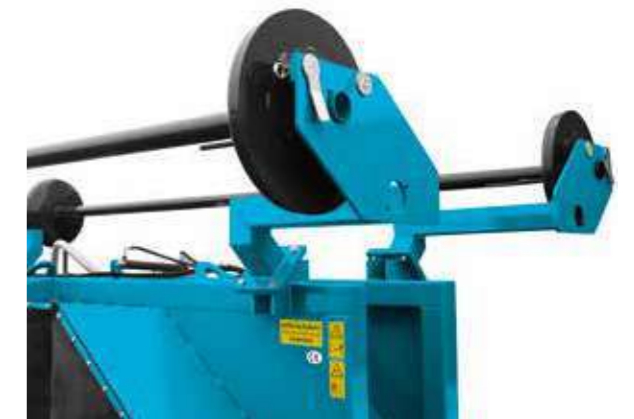
Los sistemas de enrollado y desenrollado de lonas de compostaje están disponibles en todos los modelos.
